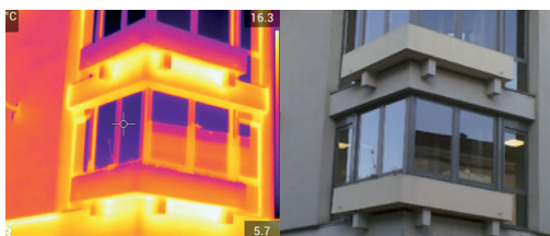
Figure 1 : thermographie façade extérieure, mise en évidence des défauts structurels
